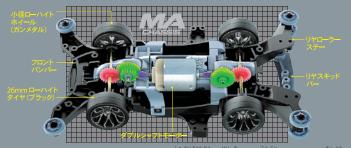
ライキリは、ダブルシャフトモーターを車体中央に配置したMAシャーシを採用。 安定性や駆動効率などの走行性能はもちろん、扱いやすさも兼ね備える一体型 シャーシだ。低摩擦タイプローラーやリヤスキッドバー、3.5:1の超速ギヤも付属。
