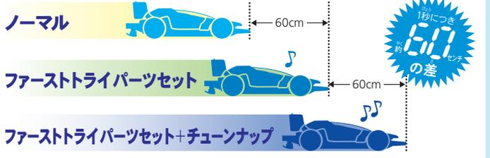
タミヤテストコースでの走行計測時間から平均計算すると、1秒たつごとに約60センチずつ3つのマシンの距離が開く結果となった。それぞれのマシンが走るほどに差がひらくのがわかるはず。10秒間走行すれば約6mの差に。これは大きいぞ。
