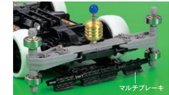
リヤダブルローラーが、カーブでの遠心力を上下2つのローラーでガッチリ受け止めスムーズなコーナリングを実現。さらに、スロープなどの上り坂でブレーキをかけコースアウトを防ぐ、マルチブレーキも装着し安定性をアップさせた。
