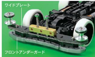
ワイドステーの上にワイドプレートを手前と後ろに重ねてさらに強度をアップ。コーナー突入時に強い力が加わっても、プレズにスムーズなコーナリングに。もし、コースフェンスにのりあげた時もアンダーガードがあればコースに復帰しやすいぞ。
