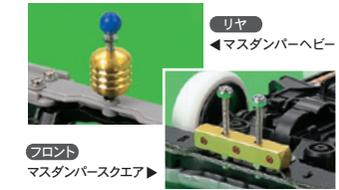
ジャンプセクション後の着地での車体のはね上がりや打ち消すマスダンパーを前後に装着した。上下方向のマシンのバタつきが少なくなり姿勢が安定するので、タイヤがすぐに路面に接して加速力のアップにつながるのだ。
