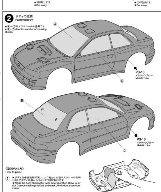
★塗装が乾いたらマスクシールをはがし、ウインドウ部分を内側からスモーク (PS-31) で塗装します。その後、ボディ表面の保
