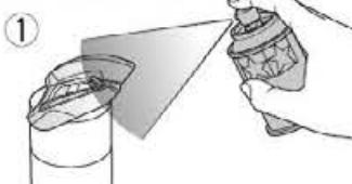
★パーツを中性洗剤で洗い、よく乾かした後、保護フィルムが貼られていない裏側を塗装します。
