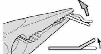
★バッテリーの搭載に便利なようにスナップピンを折り曲げます。
