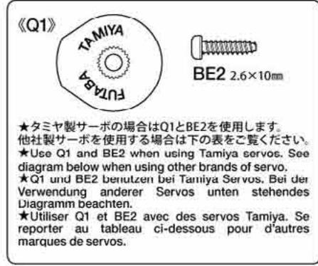
《サーボホーン用ビスの選び方》 / Selecting Servo Horn Screw
