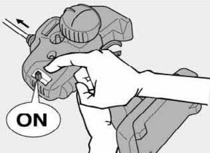
① 送信機のアンテナをのばし、スイッチをONにします。
