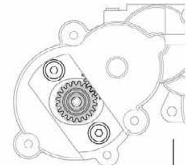
★ギヤが軽くまわるようにすき間を調節してモーターを固定してください。
