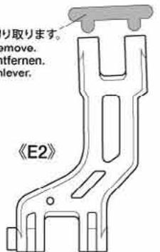
★取り付け部の形に合わせて差し込みます。
