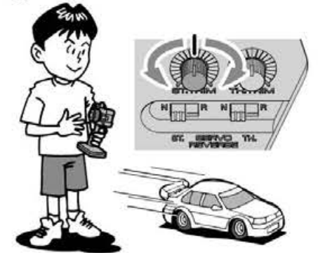
④ ステアリングを使わず走らせてみます。まっすぐに走らない場合はステアリングトリムを使って調節してください。
