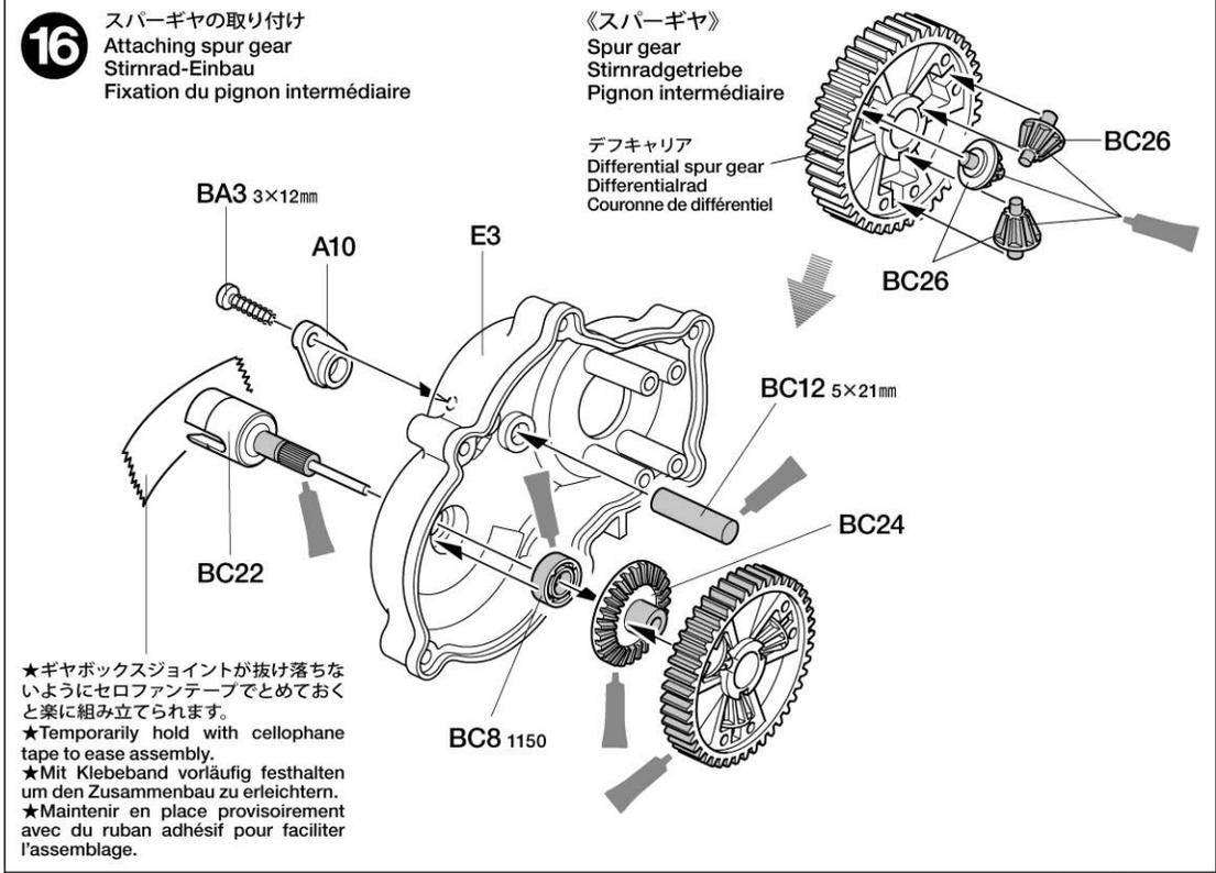
★ギヤボックスジョイントが抜け落ちないようにセロファンテープでとめておくと楽に組み立てられます。
