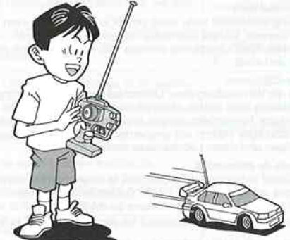
④ ステアリングを使わず走らせてみます。まっすぐに走らない場合はステアリングロッドのアジャスターを調節してください。
