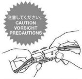
走行させない時は必ず走行用バッテリーのコネクターをはずしてください。走行用バッテリーをつないだままでおくと、車が暴走することがあります。走らせないときは、必ず走行用バッテリーのコネクターを抜 いておきます。
