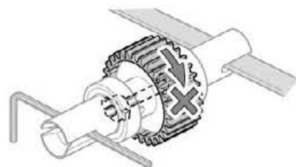
★デフジョイントを固定して、デフキャリアがすべらないことを確認します。デフキャリアのすべりは、デフスクリューのネジ込みで調整します。
