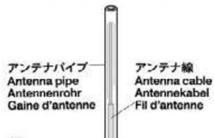
★アンテナ線が外に出ないような長さに切って取り付けます。(アンテナ線保護用)
