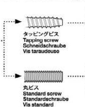
★使用するサーボの取り付け部に合わせて選びます。
