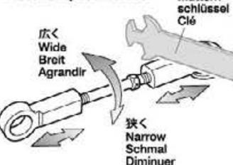
★タイロッド、アッパーアームのターンバックルシャフトは板レンチを使って長さを調整することができます。
