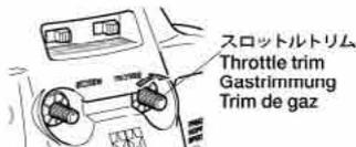
④ プラグにプラグヒーターをセットし、リコイルスターターをすばやく引いてエンジンをかけます。このとき、送信機のスロットルトリムを少し右に回しておくとうエンジンがかかりやすくなります。エンジンがかかったら2、3度ハーフスロットルまで回転を上げ、アイドリングを安定させ、トリムをもとの位置までもどしてください。
