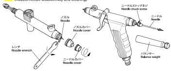
①塗料カップとバランサーを取り外します。②メインレバーをマスキングテープ (セロハンテープ) で固定し、メインレバ ーが抜け落ちないようにします。(ボタン式のみ)③ニードルストップネジをゆるめ、ニードルを取り外します。④ニード ルカバーを取り外します。③ノズルカバーを取り外します。⑥ノズルレンチを使ってノズルを取り外します。⑦クリーニン
