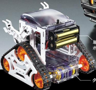
教育用マイコンボード「BBC マイクロビット」、超音波センサー、駆動回路を搭載した、クローラー走行のロボット工作セットです。超音波センサーが障害物を感知すると、その情報をBBC マイクロビットが受け取り、インストールされた走行プログラムを基に2つのモーターをコントロール。障害物をよけて自動走行します。さらに別売パーツを組み合わせれば、前後進・左右旋回の無線操縦が可能。もちろん、お手持ちのパソコンでBBC マイクロビットを自分でプログラミングすれば、自由に動きをコントロールすることも可能です。★単3形電池2本使用(別売)。
