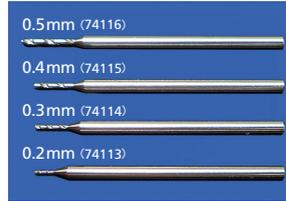
精密な浅穴加工に最適なドリル刃です。ピンバイスに取り付ける部分の軸径が1.0mmとドリル刃に較べて太くなっているため、確実に取り付けられ芯ブレしにくいのが特長。材質は高速度鋼、優れた切れ味はもちろん耐久性も十分です。
