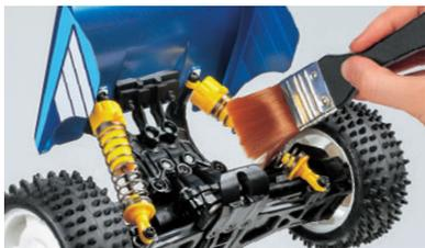
車体の清掃は、塗装用の大きめのハケを使えば砂やホコリを簡単に落とせます。また、細かな箇所は歯ブラシや小さめのハケを使うのもいいでしょう。エアークンプレッサーを利用できる場合はエアの圧力で汚れを手
