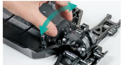
ギヤケースなど駆動部分は、ビスを締め込みすぎると回転が重くなる場合があるので、ギヤを手で回してチェックしよう。
