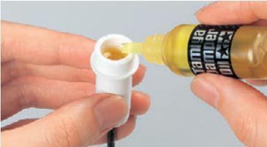
サスペンションはクラッシュなどで痛みやすい部分です。アームの曲がりやネジ穴の痛み、取り付け部のガタなどをチェックして、痛みがひどいようならパーツを交換しましょう。また、ダンパー内のオイルは走行する度に少しずつ減っていますので継ぎ足します。その際、オイルが汚れていればオイルを新しく入れ直すのがベストです。ダンパーからオイルが漏れているようならシール用のOリングが傷んでいる証拠、新品に交換しましょう。同時に、ダンパーシャフトにキズや曲がりがないかもチェックします。特に、ダンパーシャフトのキズはOリングを痛めてしまうので新品と交換するのがお勧めです。
