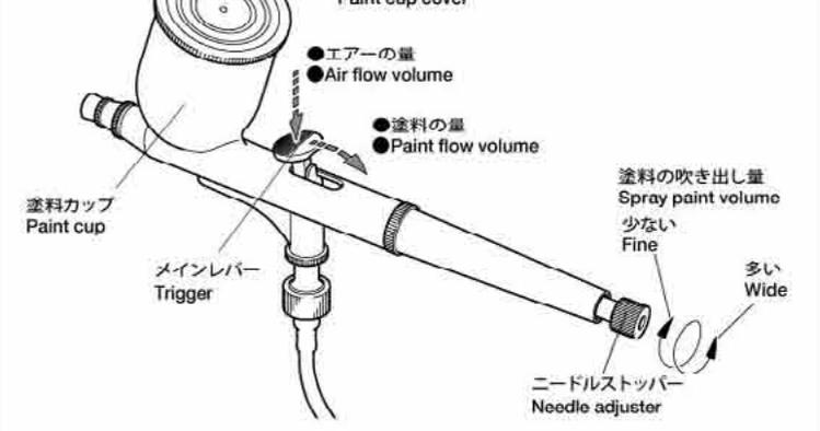
★ニードルストッパーをゆるめる(反時計回り)と塗料の量が多くなり、しめる(時計回り)と少なくなります。このネジをしめていくと、メインレバーを手前に引ける量も少なくなります。つまりニードルストッパーは塗料の最大吹き出し量を制御するものです。
