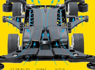
空力性能を追求したARシャーシやMAシャーシの持ちようを受け継いで、底面は凸凹の少ない滑らかなスタイルに仕上げられた。流れるような2本のメインフレームがフロントバンパーからリアバンパーまでつながり強度も十分。空気の流れを重視した形が各部に採用されている。電池の発熱を冷却するための専用スリットも装備するなど、シャーシ全体でさらなる性能アップを図っているぞ。
