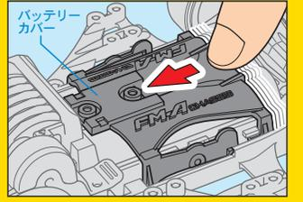
2点で固定していた今までのシャーシに比べて4点で固定して電池を確実にロック。電池のパワーをモーターにロスなく伝えるぞ。さらにマスタンプ装着などの拡張性を高めるの穴や、電池の熱を逃す形状など、走りのためのバッテリーカバーなのだ。
