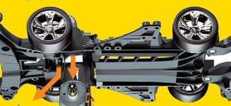
モーター交換はアンダーパネルをはずして下側からアクセス。ギャボックスのギャを外さなくても交換できるのでセッティング変更も楽々。駆動効率も向上しているぞ。
