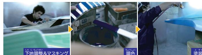
ボディにサーフェイサーを吹いて下地の調整をしたら、塗装しない所はマスキングテープで保護。塗料を調色して一気に塗装するぞ。ボディの曲線が映える透明度の高い塗料を使ったり、ハンドペイントなどのこだわりがギッシリだった特殊塗装だ。
