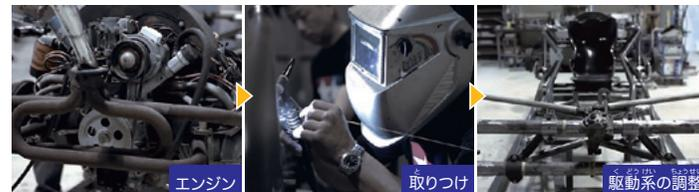
シャーシにエンジンをとりつけ、その力をタイヤまで伝えるための駆動系を整備する。また、実車を運転するためのステアリングやシート、アクセル、ブレーキなども調整して、しっかりと運転ができる状態にしあげるのだ。
