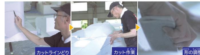
ボディ製作の元となる原型を発泡スチロールで作る。ボディラインを描き込みながら、切って削って整えてマシンイメージに近づけていく。ミニ四駆をそのまま拡大するだけだと逆に小さく見えるので、ボディの持ちようをいかして形を調整しているぞ。完成後は型を作成し、ボディをFRPで成形するのだ。
