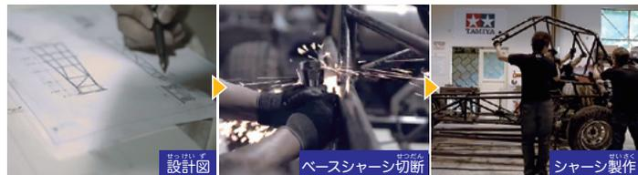
まずシャーシの設計図を作成。それをもとにベースとなるフレームシャーシの使わない部分を切断し、必要な部分は溶接してじょうぶな構造を作る。人が運転する位置、アクセルペダルの配置など、最適なポジションを決める最初の工程だ。
