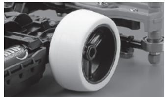
オフセットトレッドタイヤは、まさつ抵抗が少なくスムーズにコーナリングできるハードタイプをチョイス。写真のように内ばきにすれば、さらにコーナーでのスピードがアップ。姿勢が不安定になるなら外ばきを試してみよう。
