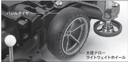
強度が高く軽量な5本スポークの大径ホイールに、接地面積が少ない、バレル (たる形) タイヤを装着。走行時にコース路面からの抵抗が少ない大径バレルタイヤで最高速をさらにアップ。ハイスピード走行を可能にするのだ。
