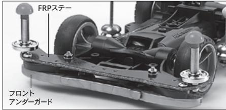
FRPステアでフロント周りの強度をアップ。コーナー突入時に強い力が加わっても、ブレずにスムーズなコーナリングに。もし、コースフェンスにのりあげた時もアンダーガードがあればコースに復帰しやすいので完走率もアップする。
