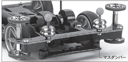
カーブでの遠心力を上下2つのローラーでガッチリ受け止めるスムーズなコーナリングを実現。さらに、レールチェンジやテーブルトップでのマシンの上下動を抑えてコースアウトを防ぐマスダンパーも装着し、安定性をアップさせた。
