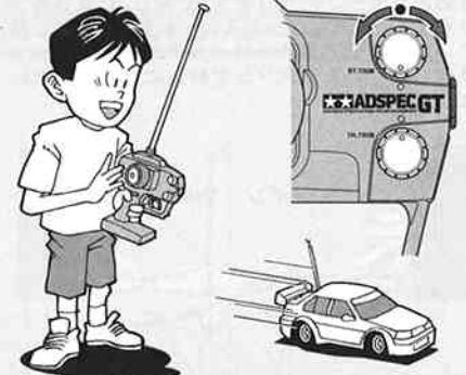
④ ステアリングを使わず走らせてみます。まっすぐに走らない場合はステアリングトリムを使って調節して下さい。
