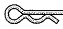
MC9 ・×4 50197 スナップピン(小) Snap pin (small) Federstift (klein) Epingle métallique (petite)
