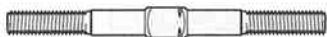
MB18 3×42mm ターンバックルシャフト ×2 Turn-buckle shaft Spann-Achse Biellette à pas inversés
