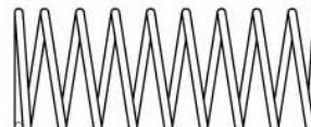
BD7 ×2 19805484 リアコイルスプリング Rear coil spring Hintere Feder Ressort hélicoïdal arrière
