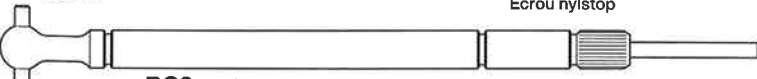
BC8 ×2 3485158 デフシャフトA Diff shaft A Ausgleichsradachse A Arbre de différentiel A
