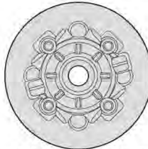
MA45 ギヤデフプーリーケース Differential case Differentialgehäuse Carter de différentiel x1 51643
